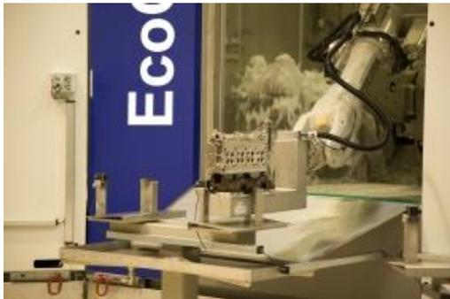
Durch Energieeffizienzmaßnahmen konnte der Strom- und Wasserverbrauch einer seit mehreren Jahren betriebenen Roboterzelle EcoCflex Classic um rund 30 Prozent verringert werden.
